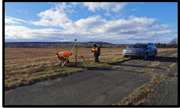
Figure 4- Courtney Roddick, CLS et André Bédard installant un récepteur GPS sur le point de contrôle du Nouveau-Brunswick 5510 (ME/NB)
