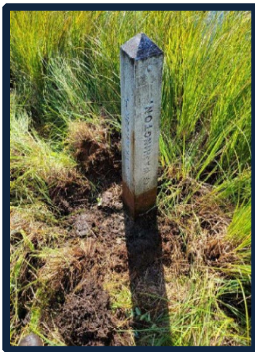
RM 509, borne de type obélisque enterrée dans des conditions marécageuses. (NH/QC)
