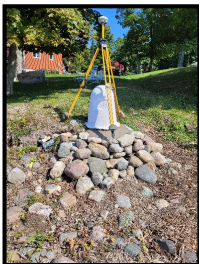
Observations GNSS sur la borne de référence 13 fraîchement renouvelée.
