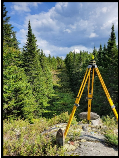
Installation sur une borne frontalière aux fins d'arpentage.
